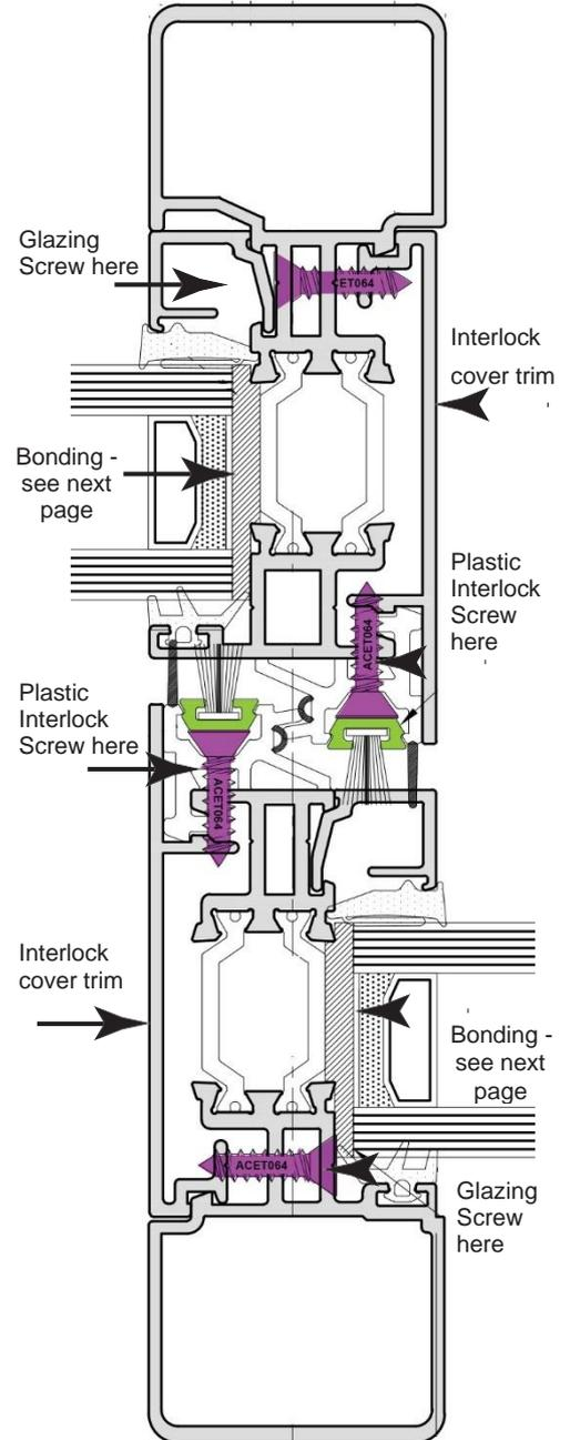
TRIPLE TRACK SLIM INTERLOCK FITTING GUIDE
